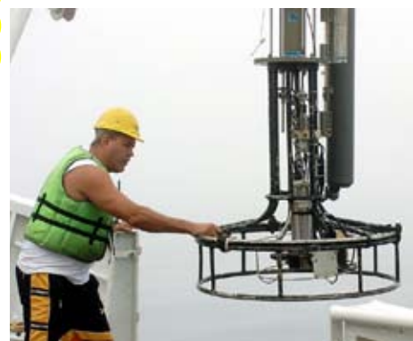
No alto, medição radiométrica; dejetos do emissário de Santos; e o equipamento Rosete, usado para coleta de águas e medição
